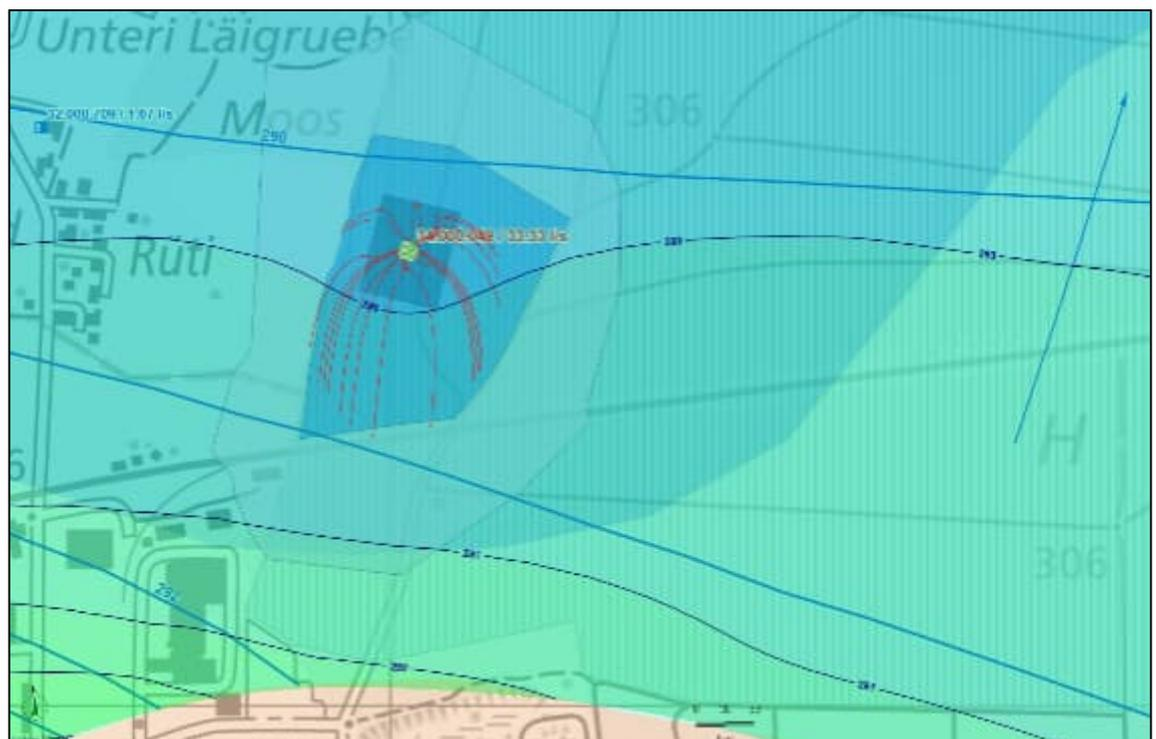
Abbildung 24: 10-Tages-Isochronen bei NW von GWPW Hardwald und GWPW Ägerte (4'500 bzw. 9'000 l/min)
